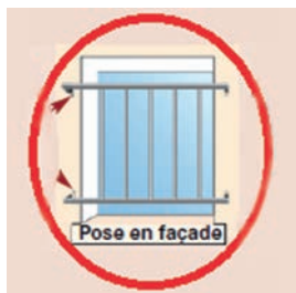
Pose en façade
